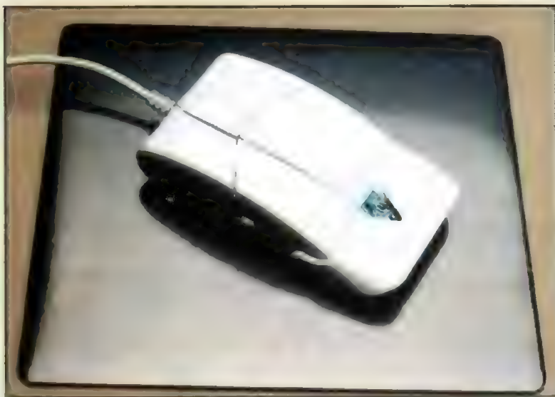
5. Optical WinMouse razem ze specjalną podkładką podzieloną na setki drobnitkich kratek. Mysza wyposażona jest w parę czułych oczu zliczających mijane kratki na podkładce.
